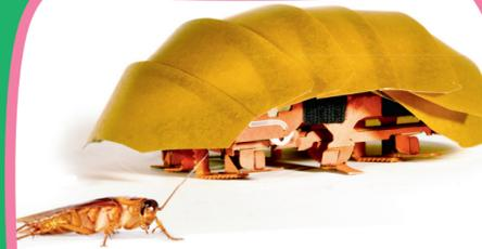
Les **robots sauveteurs** peuvent rechercher des survivants après une catastrophe naturelle, comme ce robot inspiré du cafard, capable de s'aplatir pour se faufiler sous les décombres.
